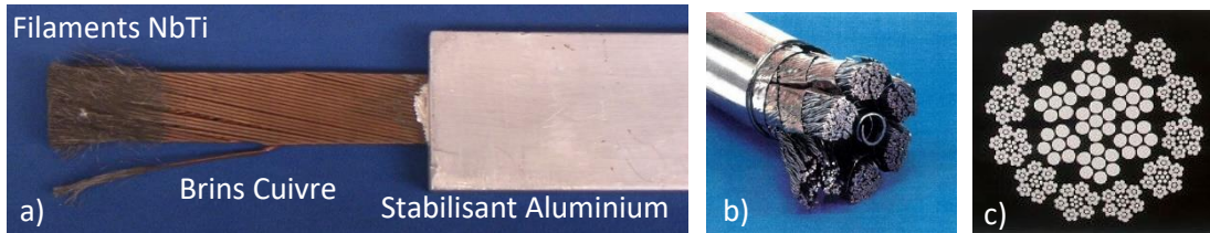
a) Conducteur NbTi du toroïde Atlas BT (CERN), b) Câble en Conduit (Iter TFMC), c) Câble AC 12x[6(6+1)] Supra
