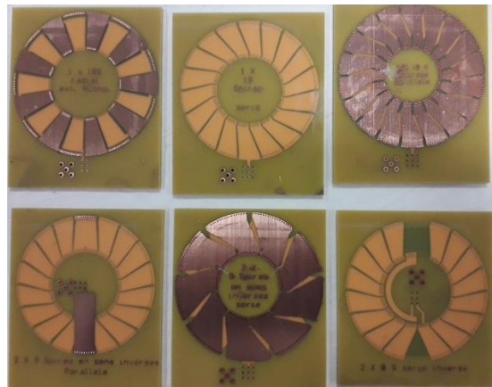
Figure 2 Incorporation dans le circuit imprimé Inducteur
