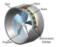
Figure 1 : Schéma de principe d'un propulseur Rim-Driven
