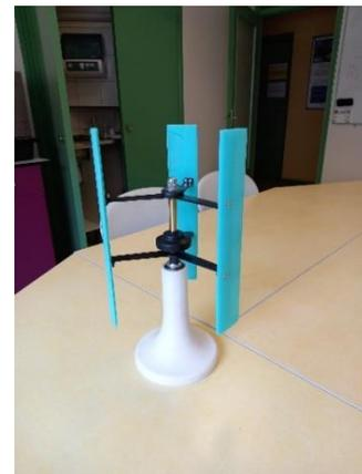
Figure 2 : Soufflerie anéchoïque du LMFA (gauche) et maquette à échelle d'une éolienne à axe vertical (droite).
